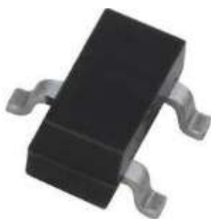
Диоды Шоттки типа КДШ158 в малогабаритном корпусе SOT-23
