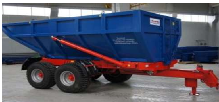
Полуприцеп тракторный для жидких фракций ПТСЖ-12
