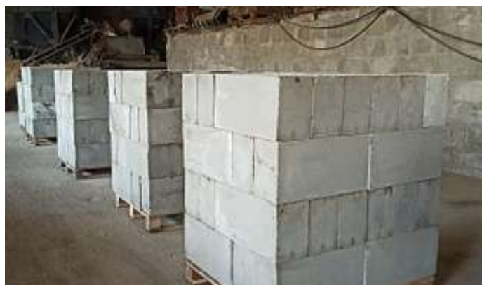
Пенобетонные блоки (Пеноблок): 600-300-200 мм / 400-300-200 мм / 600-300-100 мм
